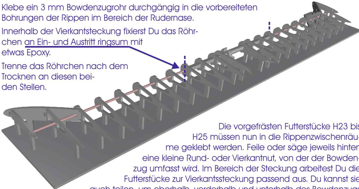
Die vorgefrästen Futterstücke H23 bis H25 müssen nun in die Rippenzwischenräume geklebt werden. Feile oder säge jeweils hinten eine kleine Rund- oder Vierkantanut, von der der Bowdenzug umfasst wird. Im Bereich der Steckung arbeitest Du die Futterstücke zur Vierkantssteckung passend aus. Du kannst sie auch teilen, um oberhalb, vorderhalb und unterhalb des Bowdenzugs eigene, passgenaue Einzelteile zwischen den betreffenden Rippen zu schaffen. Oder du fertigst aus Resten von Flugzeugsperr-
