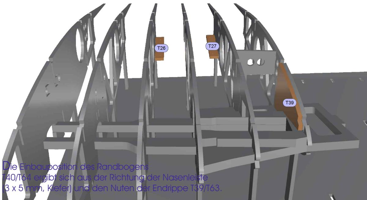
Die Einbauposition des Randbogens T40/T64 ergibt sich aus der Richtung der Nasenleiste (3 x 5 mm, Kiefer) und den Nuten der Endrippe T39/T63.
