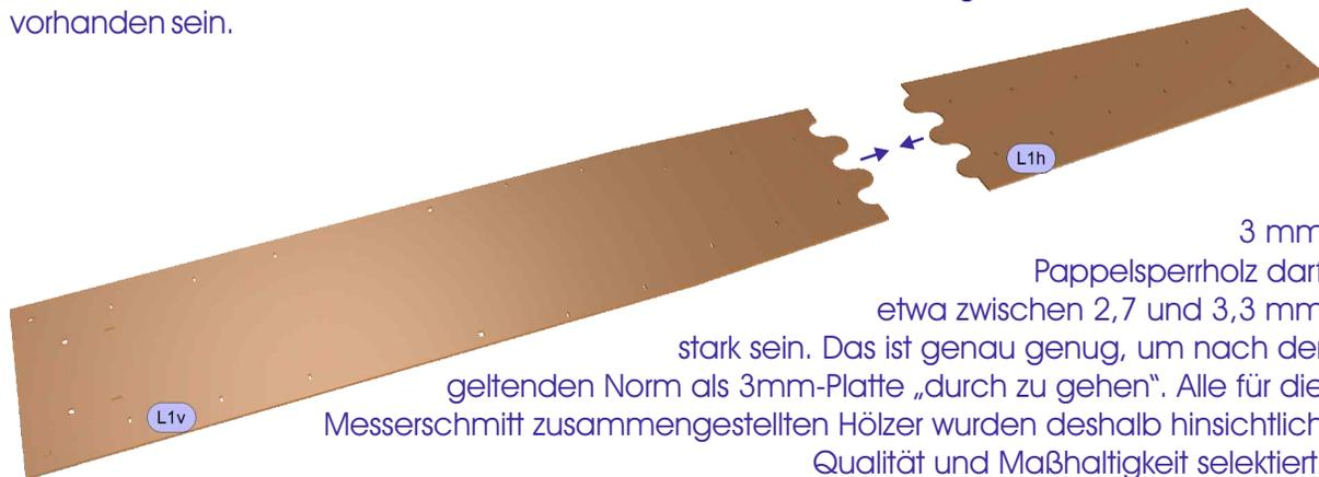
Manche Bauteile greifen allerdings schräg ineinander, deren Kanten musst Du mit einer kleinen Schlüsselfeile nachbearbeiten. Auch im Falle eines Laser-geschnittenen Bausatzes bliebe Dir diese Prozedur nicht erspart.
