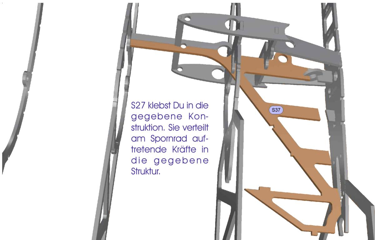
S27 klebst Du in die gegebene Konstruktion. Sie verteilt am Spornrad auftretende Kräfte in die gegebene Struktur.
