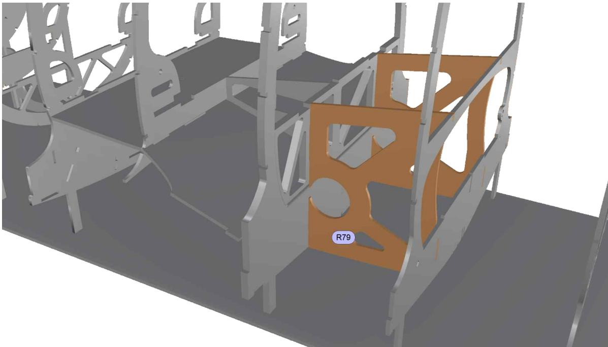
Die beiden Bauteile R79 dienen der korrekten Ausrichtung des Mantelrohres der Tragflächendeckung. Auch sie greifen in vorbereitete Nuten.
