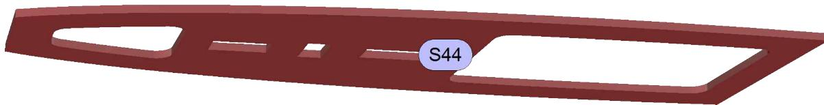
Mit der Verklebung von S3 mit S44 (Flugzeugsperrholz, 1 mm) sorgst Du für einen belastbaren oberen Abschluss des gedämpften Einziehfahrwerks.
