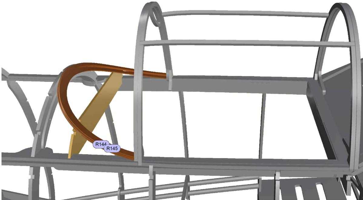
R144 und R145 folgen und werden auf R84 aufgeklebt. Nach dem Trocknen kann X1 wieder entfernt werden.
