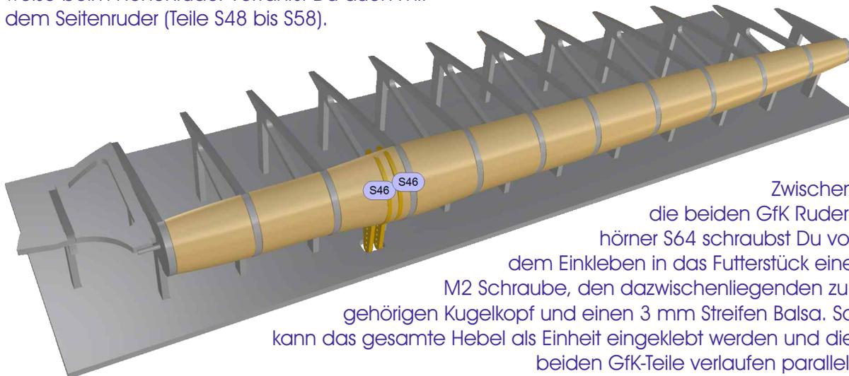
Zwischen die beiden GfK Ruderhörner S64 schraubst Du vor dem Einkleben in das Futterstück eine M2 Schraube, den dazwischenliegenden zugehörigen Kugelkopf und einen 3 mm Streifen Balsa. So kann das gesamte Hebel als Einheit eingeklebt werden und die beiden GfK-Teile verlaufen parallel.
