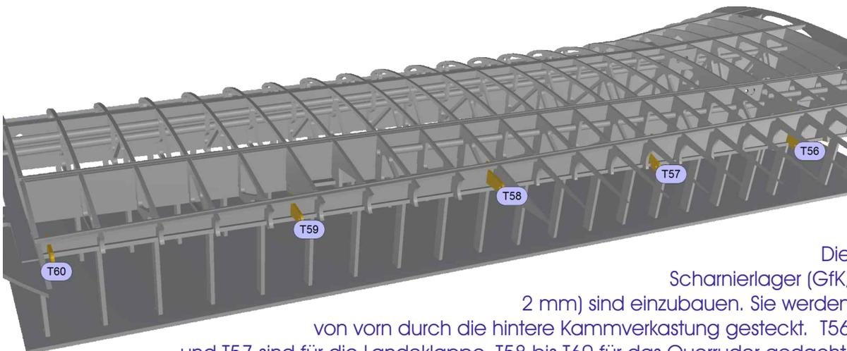
Die Scharnierlager (GfK, 2 mm) sind einzubauen. Sie werden von vorn durch die hintere Kammverkastung gesteckt. T56 und T57 sind für die Landeklappe, T58 bis T60 für das Querruder gedacht. Die Einkerbungen zeigen nach oben.
